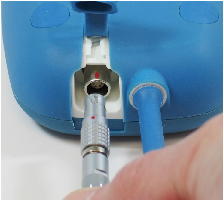
Abbildung 8: Ausrichten der DC-Steckverbinder
